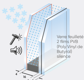
Vitrage 4 ITR/16 argon/44.2 Silence Verre acoustique et sécurité Coefficient Ug 1.1
